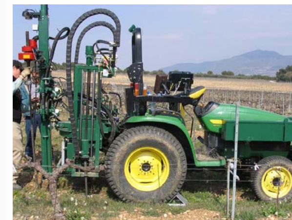
Le Tracteur du Système SIS effectuant un sondage. (Les Côtes-Vinsobres).
